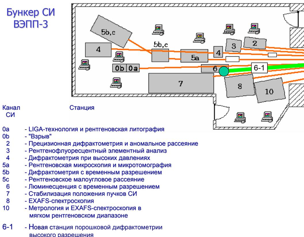
Рис. 1. Схема размещения экспериментальных станций в бункере СИ на ВЭПП-3.
