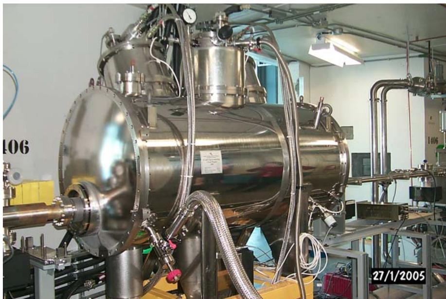
**Рис. 32.** 63-полюсный вигглер с полем 2.2 Тл на накопителе CLS (Канада).
