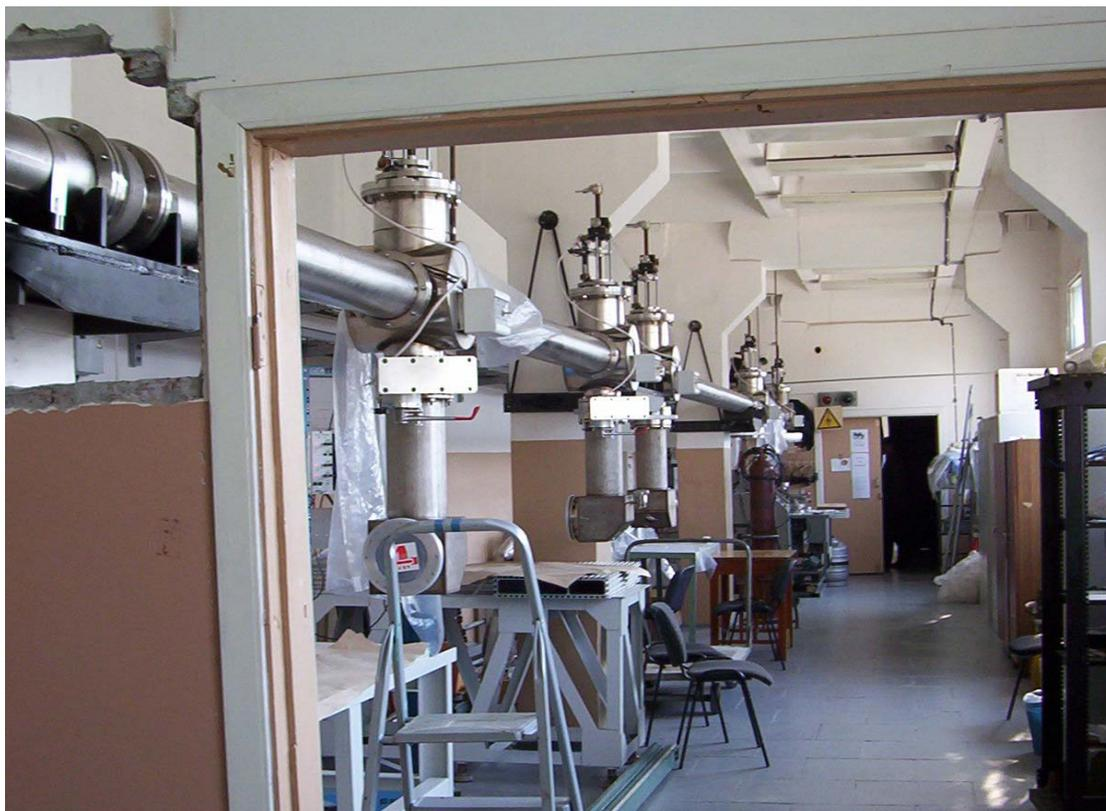
**Рис. 25.** Канал в зале для пользователей перед монтажом станций. Видны спуски к будущим экспериментальным станциям.
