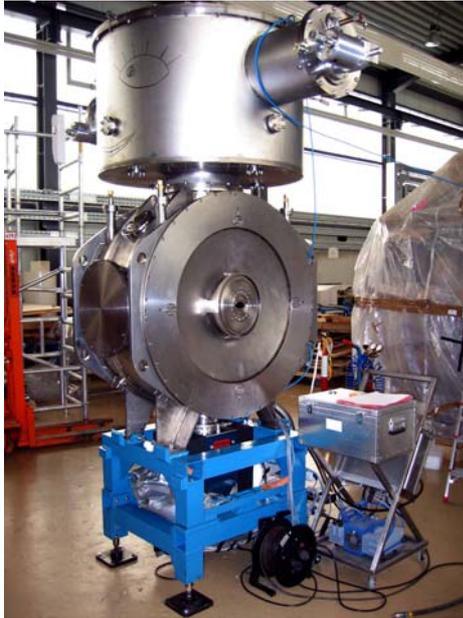
**Рис. 39.** Сверхпроводящий поворотный магнит с полем до 9.6 Тл во время испытаний (BESSY-II, Берлин, Германия, июнь 2004 г.)
