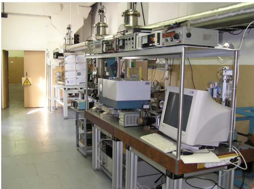
**Рис. 26.** Общий вид диагностической станции (станция для измерения параметров терагерцового излучения).
