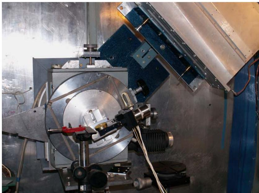
**Рис. 15.** Станция «Дифракционное кино». Вид гониометра с детектором ОД-3.
