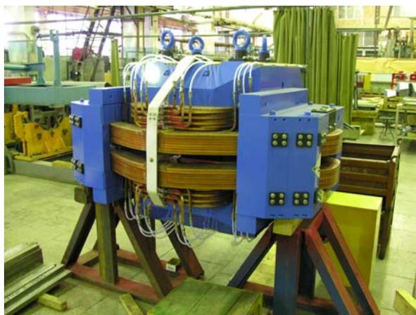
**Рис. 35.** Супербенд с полем 3 Тл для SLS (PSI., Швейцария).
