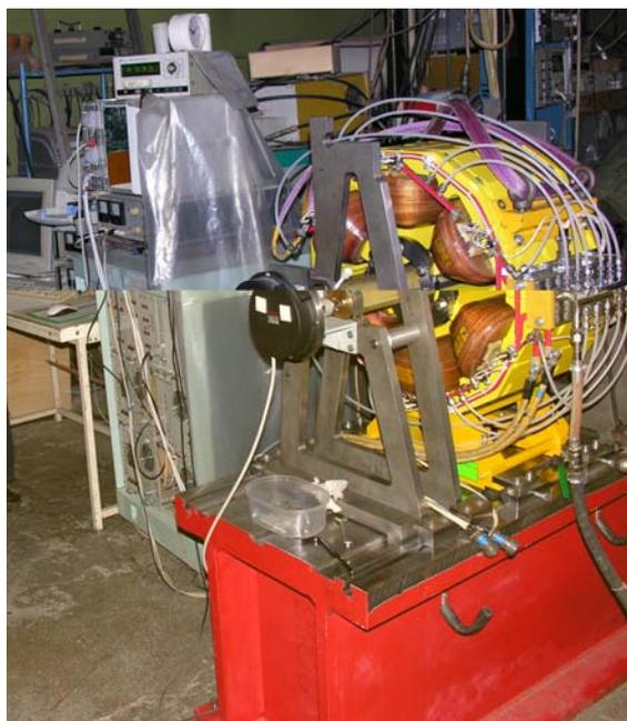
**Рис. 36.** Магнитные измерения секступольной линзы для Diamond.
